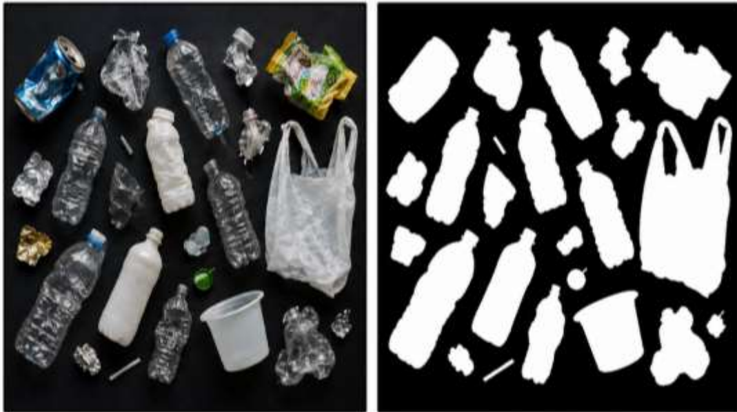
Gambar 2. Hasil segmentasi biner objek sampah ambigu menggunakan algoritma Fuzzy C-Means
