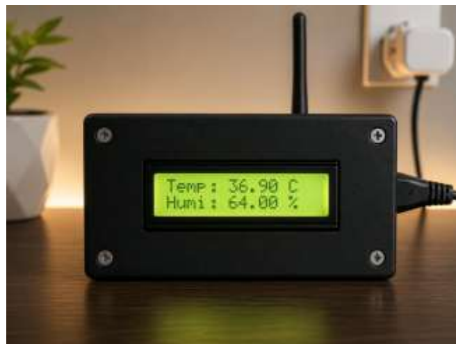
Gambar 3. Dokumentasi pengujian pembacaan suhu dan kelembapan
