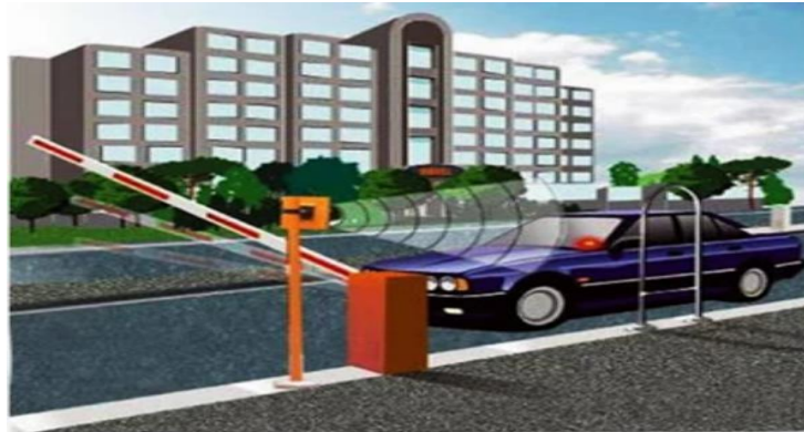
Gambar 8. Palang otomatis terbuka setelah Terbaca Oleh Komputer
