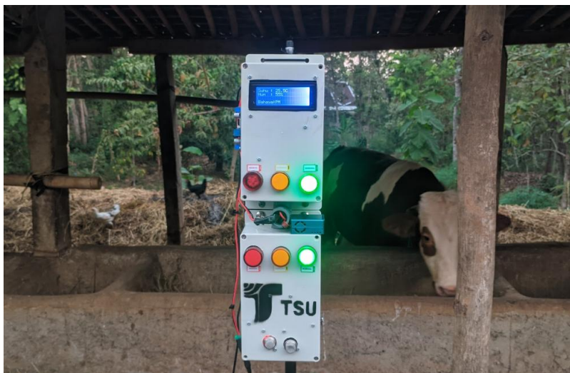
Gambar 4. Smart Livestock Health System Untuk Monitoring Kondisi Lingkungan Kandang
