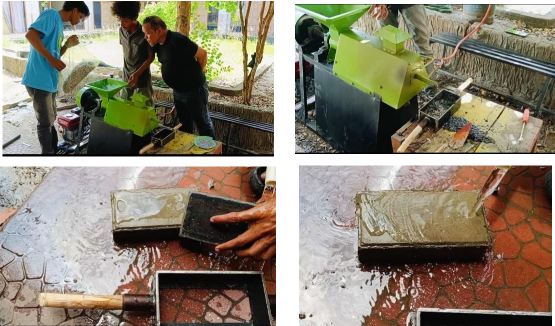
Gambar 5. Proses pelelehan sampah plastik dan pencetakan
