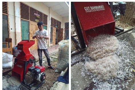
Gambar 4. Proses pencacahan sampah plastik
