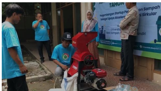
Gambar 4. Proses pencacahan sampah plastik
